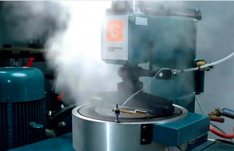
На испытательном стенде были получены следующие показатели коэффициента трения при температурах 100–350 °C:
