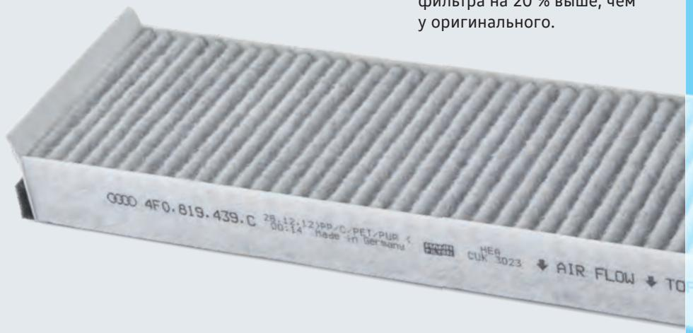
Вследствие использования материала, не соответствующего требованиям завода-изготовителя, контрафактный фильтр со временем может стать причиной повреждения системы кондиционирования: вентилятора печки, деталей исполнительных механизмов заслонок и сервоприводов.
