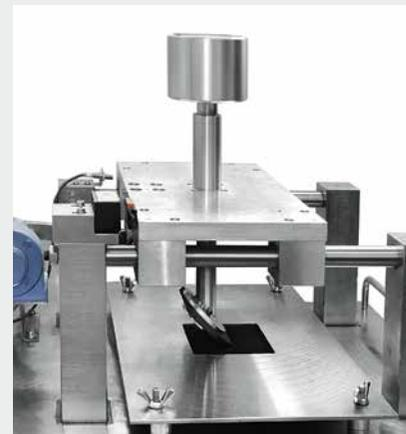
Устройство для проведения «испытания каблуком»
