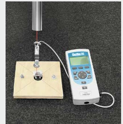
Тестирование прочности фиксаторов для ковриков
